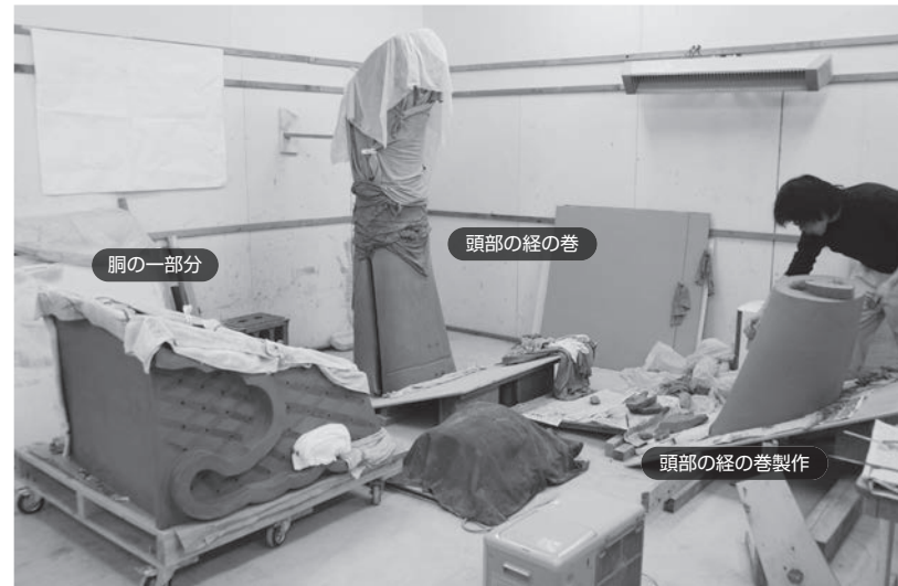
成形が済み乾燥中の大棟獅子口瓦のパーツ
