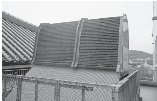
大棟の模型を用いた瓦の葺き方の実験
